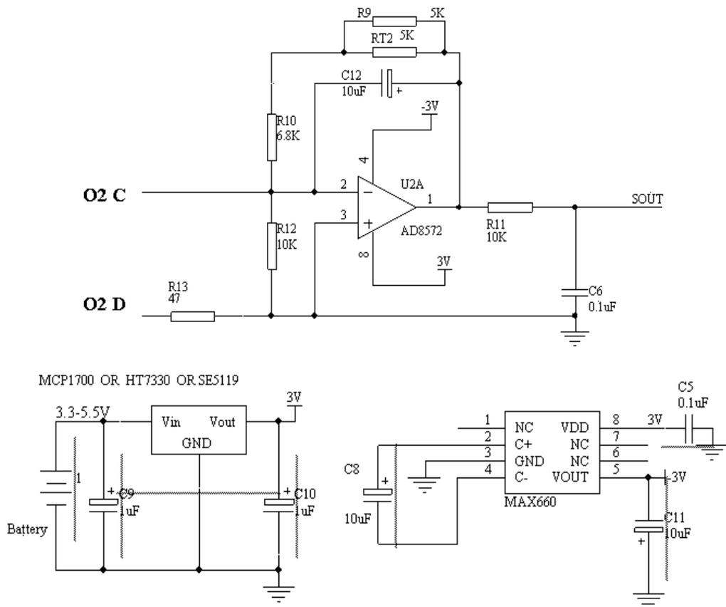
图 2： 氧气传感器测试电路
